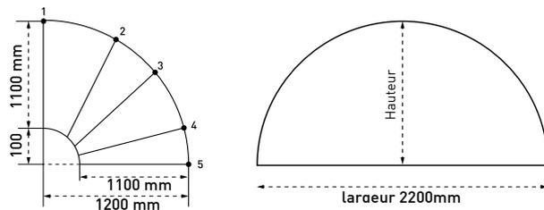
Hauteur et avancée =  $\text{largeur}/2 + 20\text{mm}/\text{bras}$
