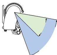
Angle 10° à 70° : Plage de garantie pour les avancées de 1500 mm à 3500 mm.
